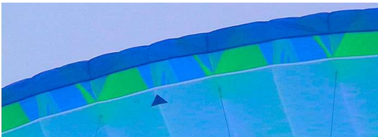
Рис. 2.7. Воздухозаборники и три вида нервюр в парaplане «Mister X» Украинской фирмы «Аэрос» (2003 г).
