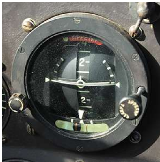
Рис. 1.12. Авиагоризонт АГК-47Б (устанавливается на самолете Ан-2).
