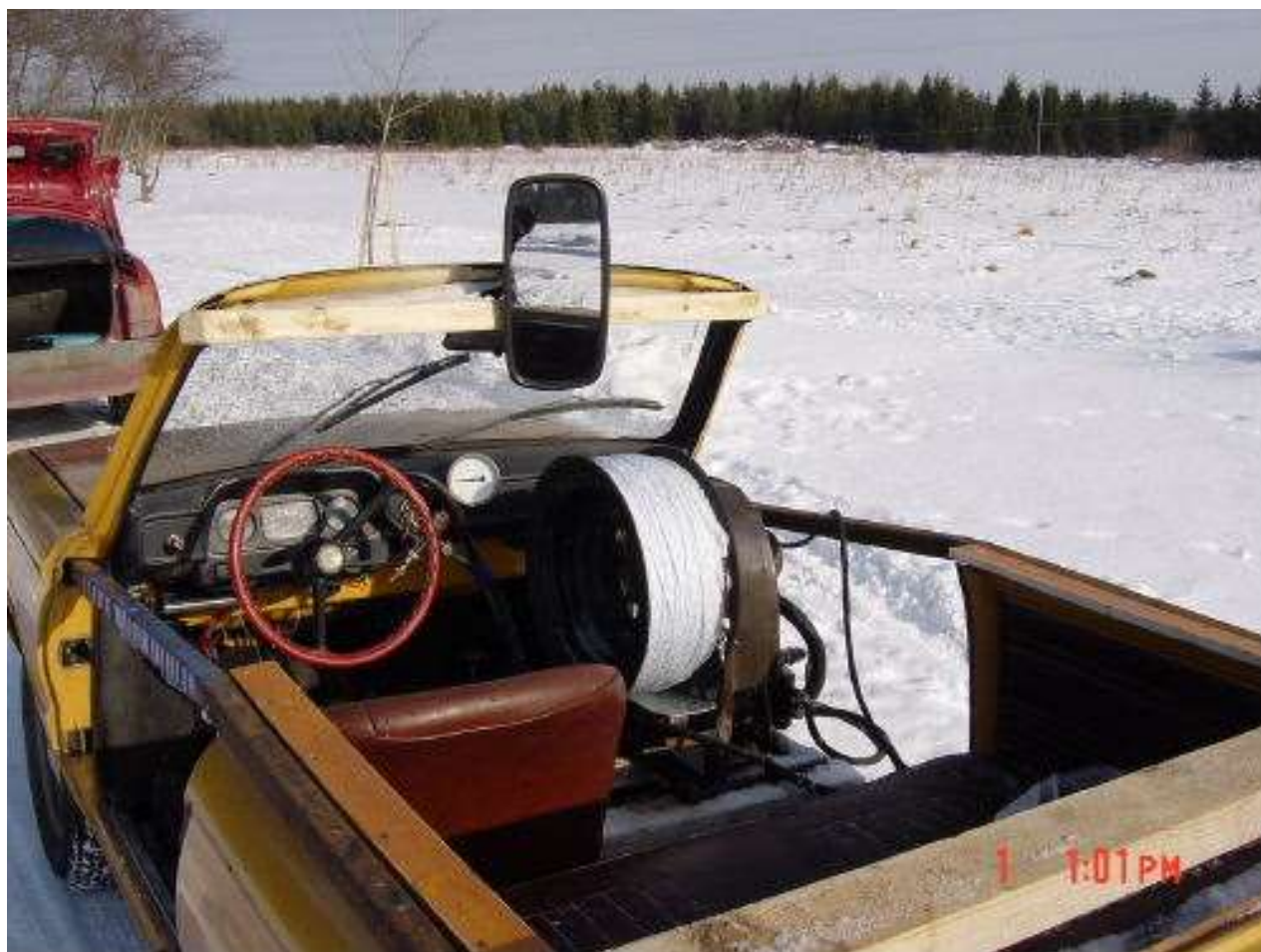
Рис. 3.35. Пассивная гидравлическая лебедка Николая Селиванова.
