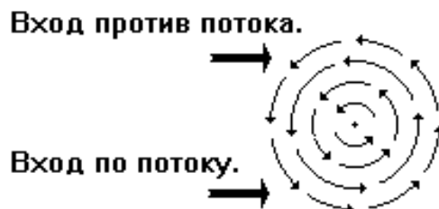
Рис. 4.24. Закручивание воздуха в ТВП в северном полушарии происходит в направлении «против часовой стрелки» (вид сверху).
