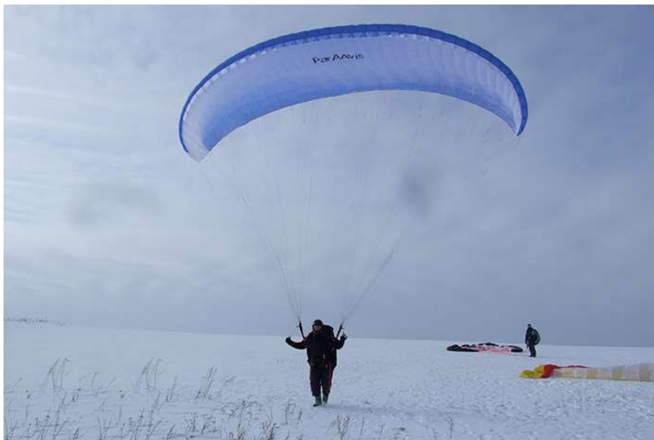
Рис. 3.15. Если спокойный учебный парашют «Танго» в размере 22 кв.м. с весовой вилкой 62-80 кг выдать пилоту весом 110 кг, получится весьма верткий аппарат, соответствующий классу безопасности «competition».
