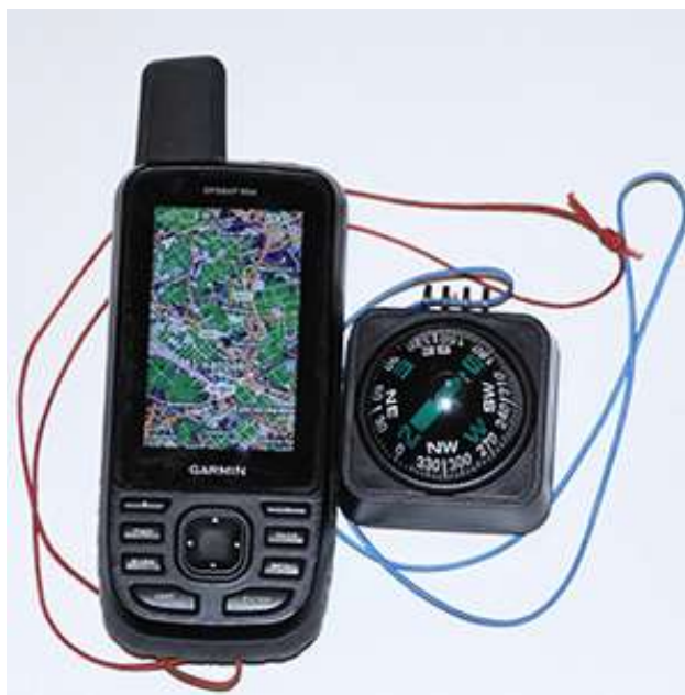
Рис. 1.14. Спутниковый навигатор Garmin-66st и сферический жидкостный компас.
