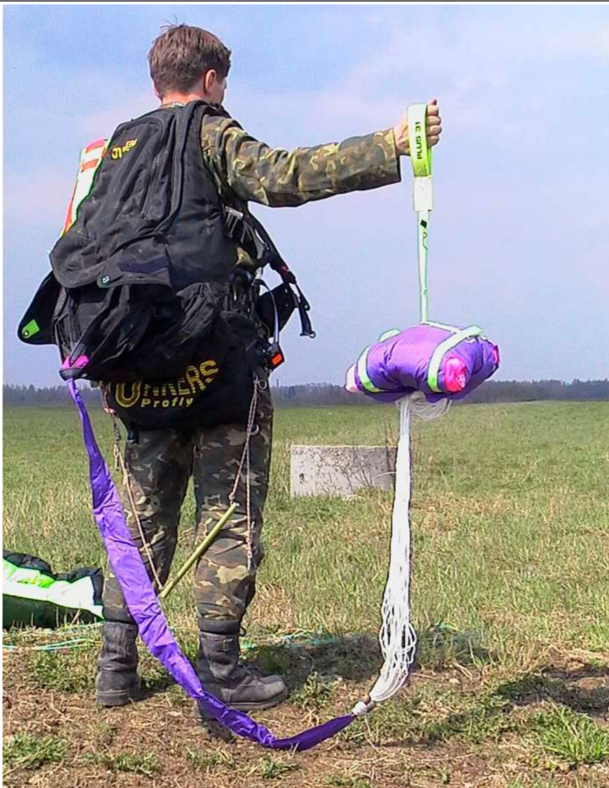
Рис. 3.50. Потянув за вытяжную ручку, пилот достает из парашютного контейнера камеру с куполом и стропами.
