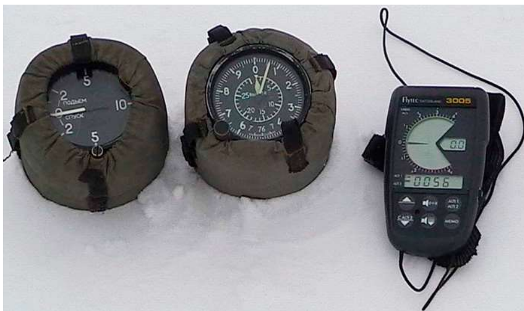
Рис. 4.32. Приборное оборудование парапланериста. Слева авиационные барометрические вариометр и высотомер. Справа комбинированный электронный прибор фирмы Flytec.
