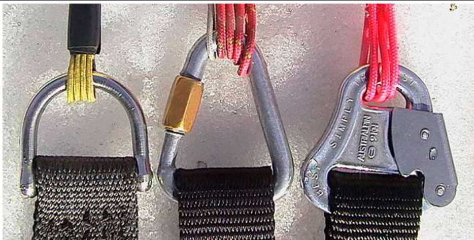
Рис. 2.17. Примеры карабинов-коннекторов строп.
