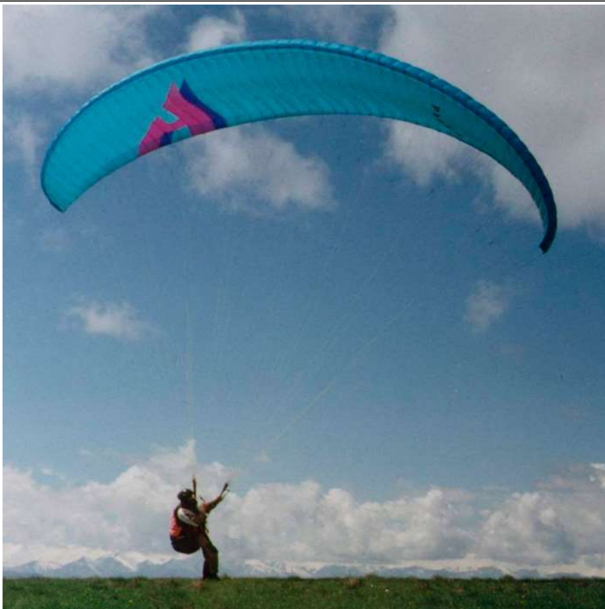
Рис. 3.12. «Корвет» – первый Российский пароплан, прошедший сертификационные испытания, создан в Московской фирме «Параавис» в 1998 году. Класс «standard» по программе «AFNOR» для площади 28 кв.м.
