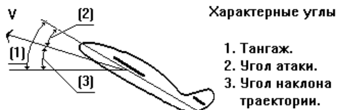
Рис. 1.17. Связь между углами тангажа, атаки и углом наклона траектории.
