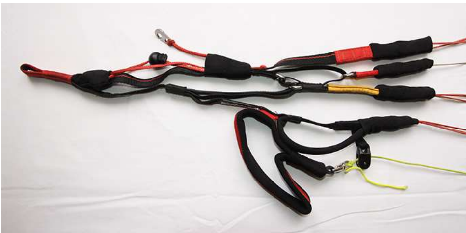
Рис. 2.20. Свободные концы парашюта «Рэй» Московской фирмы «Параавис» (разработка 2018 г) с креплением строп на софтлинках, прикрытых защитными чехлами.
