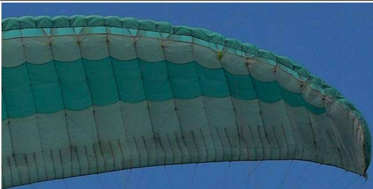
Рис. 2.6. Крыло парaplана «Стайер» с короткими хвостовыми нервюрами.
