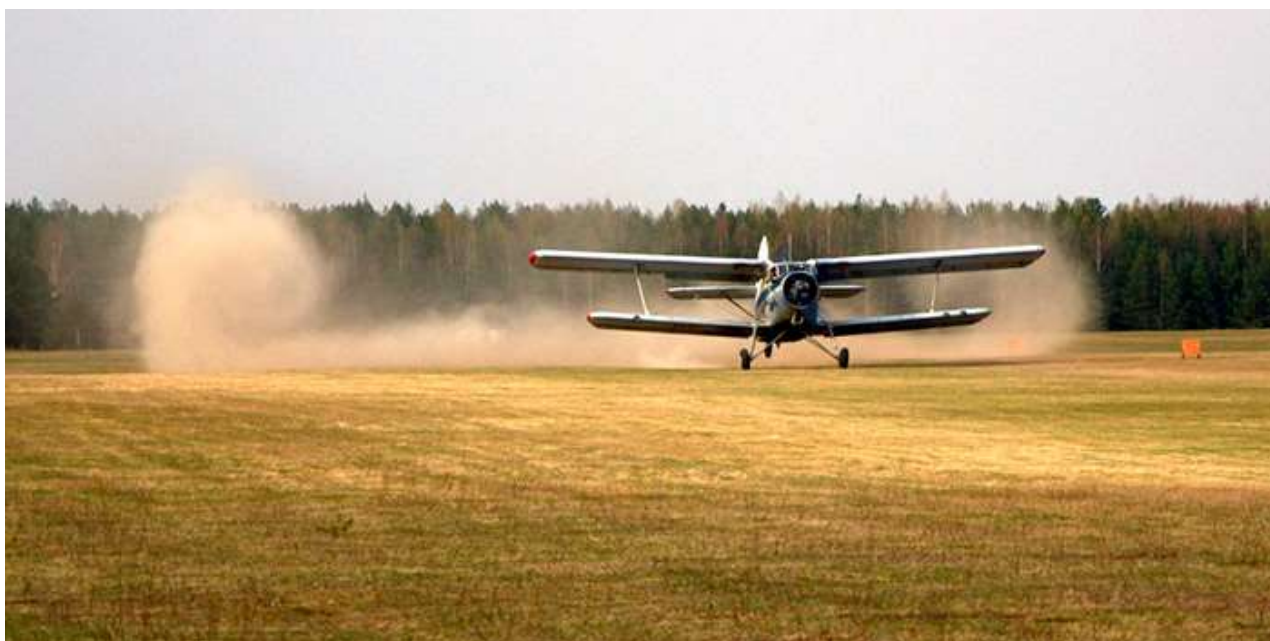
Рис. 1.46. Закрутка пыли в спутных вихрях при приземлении самолета Ан-2.
