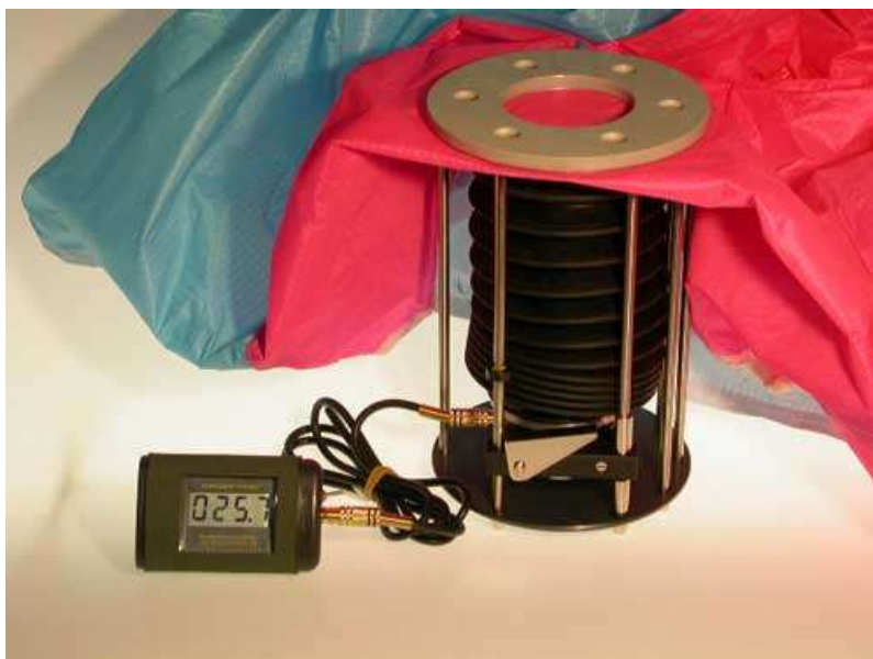
Рис. 2.12. Проверка ткани крыла парашюта порозиметром.
