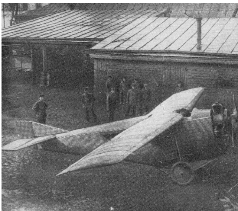
АНТ-2. Чистый моноплан, металлическая конструкция — сорок лет назад это было откровением, сенсацией, сказочно смелым шагом вперед.
